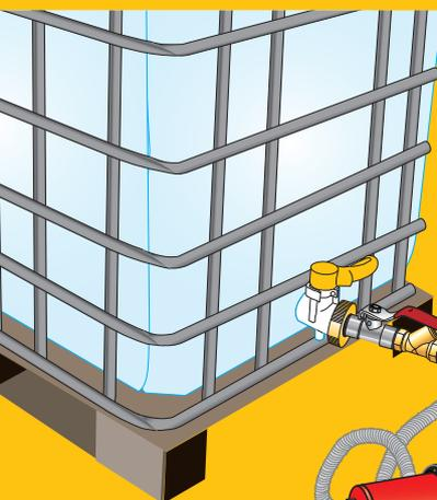
Idéal pour sortie sur une pompe (à compléter par un filtre anti-sable en sortie de vanne)
